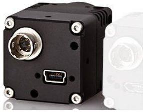
STC-MC133USB 彩色工业相机是 Sentech 的一款 130 万像素工业相机，具有硬件触发采集功能，采用 1/3 英寸高灵敏度 CCD 图像传感器，分辨率 1280×960，帧率达 22 帧/秒。该相机具有高品质图像，优秀的色彩还原，外观精巧，刚性高，价格合理等优点。采用标准 USB 接口，带有锁紧装置，四面均安装孔，安装使用简单，二次开发包方便易用。
