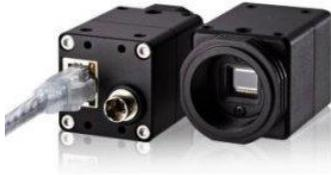
STC-SB152POEHS 黑白工业相机是一款 150 万像素、千兆网接口输出的高速工业相机，帧率达 34 帧/秒。该工业相机采用 1/2 英寸的 CCD 图像传感器，分辨率 1360×1040，具有硬件触发采集功能，符合 GigE Vision 标准，同时兼容 GenIcam，支持 IO 输入或输出。此工业相机具有外形小、重量轻、图像质量高等特点，外观精巧，3 面均设计有安装孔，安装和使用方便。
