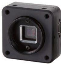
STC-SC133USB 彩色工业相机是 130 万像素 USB2.0 单板工业相机，具有硬件触发采集功能。该工业相机采用 1/3 英寸 CCD 图像传感器，分辨率 1280×960，8~12bit 图像输出，全帧曝光模式。此款相机在高速抓拍应用上能发挥其良好的性能。
