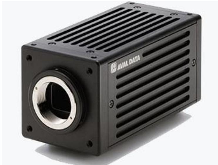
日本 AVAL 旗下的 ABA 短波红外相机系列 ABA-001IR-CL 配备先进的致冷装置，属于出色的高性价比短波红外相机，能够“看到”和捕捉人眼或普通可见光相机看不见物体变化的真实情况，采用 InGaAs 传感器技术，950 nm 至 1,700 nm 的短波红外响应，能够以较高的分辨率和拍摄速度工作，拍摄极低噪点的高质量图像，全分辨率最高达 228fps，获取超出可见光谱的高品质图像，20  $\mu\text{m}$  大像元，可以获得更高的灵敏度，性能稳定，延长曝光时间可以获得稳定质量的图像，用户可根据应用和需求不同，可选配 GigE Vision 接口 ABA-001IR-GE，可以满足低预算、高要求的应用，属于工业应用和科学成像的理想选择，为先进的机器视觉应用和高端科学成像开辟了新的可能性。
