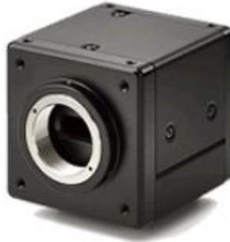
ABL-005IR-CL 采用 InGaAs 传感器技术，950 nm 至 1,700 nm 的短波红外响应，能够以较高的分辨率和拍摄速度工作，拍摄极低噪点的高质量图像，全分辨率最高达 8.13KHz，获取超出可见光谱的高品质图像，25 $\mu$ m 大像元，可以获得更高的灵敏度，性能稳定，延长曝光时间可以获得稳定质量的图像，用户可根据应用和需求不同，可选配 GigE Vision 接口 ABL-005IR-GE，可以满足低预算、高要求的应用，属于工业应用和科学成像的理想选择，为先进的机器视觉应用和高端科学成像开辟了新的可能性。
