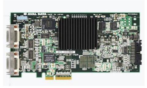
日本 AVAL 推出的 APX-3302MDR 采用 Camera Link 多接口的图像采集卡,基于 PCIe 平台,支持使用 Camera Link™线缆传输的相机,适用于连接 2 台 Base Camera Link 相机,兼容市场上的 CameraLink 厂商相机,支持 Base、Dual Base 配置的标准 Camera Link 摄像机,能够满足高级机器视觉应用的需求。特性一览
