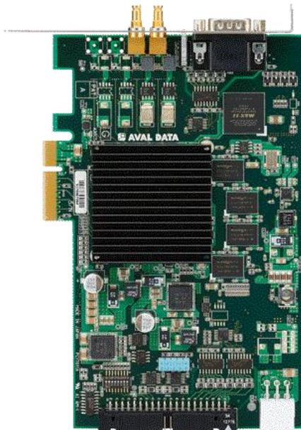
日本 AVAL 推出的 APX-3662V2 采用 CoaXpres 单接口的图像采集处理卡，基于 PCIe 平台，支持使用 CoaXpres 线缆传输的相机，适用于最多连接 1 台 CoaXpress 相机，兼容市场上的 CoaXpress 厂商相机，支持 CXP-6 single 配置的标准 CoaXpres 摄像机，采用 1 根同轴电缆视频传输，高达 12.5Gbit/s 的高速传输速度，能够满足高级机器视觉应用的需求。
