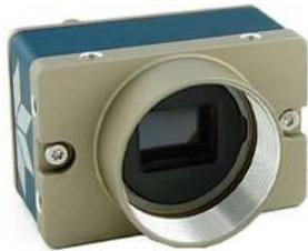
G3-GC10-C2590 彩色工业相机属于加拿大 DALSA 公司的 Genie Nano 系列面阵相机，采用 500 万像素 OnSemi Python5000 CMOS 图像传感器，分辨率 2592×2048，帧率 51fps，GigE 千兆网接口输出，支持 POE 供电。搭载 DALSA 的 TurboDrive 专利技术，具有高速、高灵敏度等特点，是 Teledyne DALSA 公司推出的一款高性价比面阵工业相机。
