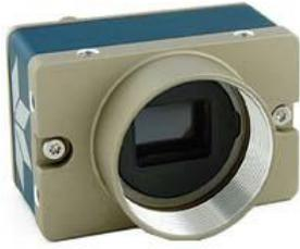
G3-GM11-M2420 黑白工业相机属于加拿大 DALSA 公司的 Genie Nano 系列面阵相机，采用 500 万像素 Sony IMX264 CMOS 图像传感器，分辨率 2448 × 2048，帧率 35fps，GigE 千兆网接口输出，支持 POE 供电。搭载 DALSA 的 TurboDrive 专利技术，具有高速、高灵敏度等特点，是 Teledyne DALSA 公司推出的一款高性价比面阵工业相机。
