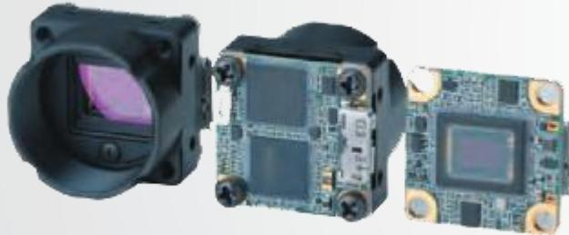
STC-BBS43U3V是一款 510 万像素的 USB3 Vision 接口的黑白相机。它采用索尼的 IMX287 传感器与先进的CMOS全局快门技术，在工业图像采集领域占据重要地位。分辨率高达 720(H) × 540 (V)，在全扫描模式下，8bit 输出时帧率可达 527.1fps，能够快速捕捉动态画面，满足对高速运动物体的监测需求。
