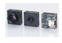
STC-BCS213GE-BL-NIR 是 OMRON SENTECH 家族的近红外相机系列,STC-BCS213GE-BL-NIR 搭载全新的红外感光芯片,高达 210 万像素,采用卷帘快门和 S-Mount 镜头接口设计,出厂可配备 M12 镜头,快门速度高达 10 微秒,帧速率达 53fps,使用 GigE Vision 作为图像输出,将高速、高分辨率和红外响应融合在一起,开放式板级外形结构,它属于功能强大的精简型板级相机,进一步缩小产品总体尺寸并实现运行灵活性,外部单独供电的机型,STC-BCS213GE-BL-NIR 属于近红外增强型,近红外性能比传统黑白相机高出许多,覆盖 400-1000nm 光谱范围。
