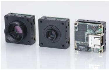
STC-BCS213POE-BL-NIR 是 OMRON SENTECH 家族的近红外相机系列，STC-BCS213POE-BL-NIR 搭载全新的红外感光芯片，高达 210 万像素，采用卷帘快门和 S-Mount 镜头接口设计，出厂可配备 M12 镜头，快门速度高达 10 微秒，帧速率达 53fps，使用 GigE Vision 作为图像输出，将高速、高分辨率和红外响应融合在一起，开放式板级外形结构，它属于功能强大的精简型板级相机，进一步缩小产品总体尺寸并实现运行灵活性，外部单独供电的机型，STC-BCS213POE-BL-NIR 属于近红外增强型，近红外性能比传统黑白相机高出许多，覆盖 400-1000nm 光谱范围。
