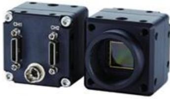
STC-CMB200PCL-NIR 近红外工业相机为日本 Sentech 生产的 200 万像素高速工业相机,采用 2/3 英寸 CMOSIS CMV2000 图像传感器,分辨率 2048 × 1088,全分辨率下帧率高达 333 帧/秒,同时实现高分辨率和高帧率。Sentech Camera Link 系列 CMOS 相机体积小、速度快、性价比高,具有 PoCL 功能,可直接通过 Camera Link 数据线缆给相机供电。
