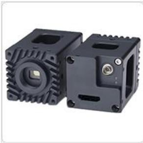
STC-LBS132U3V-SWIR 是 OMRON SENTECH 家族的 SWIR 高速短波红外相机，属于 OMRON SENTECH 最新研制的产品，搭载日本索尼公司 1.3M 红外芯片 IMX990，此款相机 130 万像素，分辨率高达 1280\*1024，帧速率达 134fps，采用 USB3 Vison 作为图像输出接口，这款短波红外相机将高分辨率、高速和红外响应融合在一起，波长 400-1700nm。并且支持硬件触发、局部扫描、相机参数编程控制等，易于开发和使用的，可以满足机器视觉红外探测、各种科研院所、大学实验室的红外探测成像的需求。砷化镓-可探测的波长较长，超过 1,000nm 的光谱探测，范围约在 900nm 到 1700nm 之间 (SWIR 短波红外)
