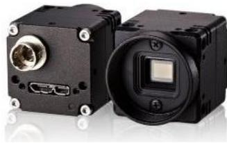
STC-MBCM401U3V-NIR 近红外工业相机是日本 Sentech 公司生产的 400 万像素、USB3.0 接口工业相机，具有硬件触发采集功能。该工业相机秉承了 Sentech 极小外形特色，采用 1 英寸黑白 CMOS 图像传感器，分辨率 2048×2048，帧率达 89 帧/秒，8~12bit 图像输出，采用全帧曝光模式。该工业相机在高速抓拍应用上能充分发挥其良好的性能。
